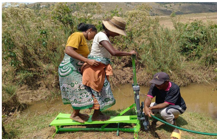
Figure 11: Essai de moto pompe lors de l'installation à Andoharena CR ANDRANOVORIVATO
