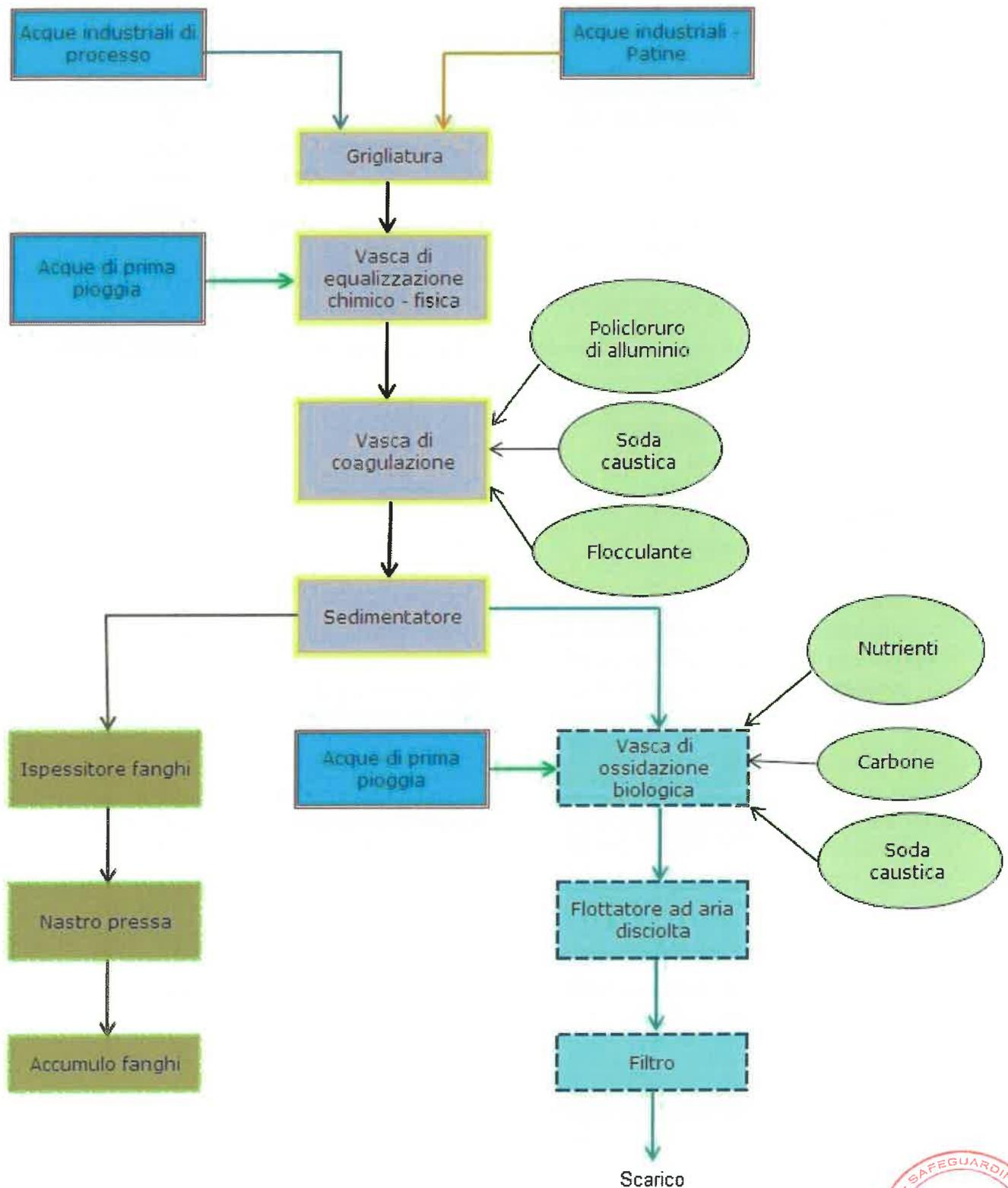
Schema a blocchi del depuratore dello Stabilimento
